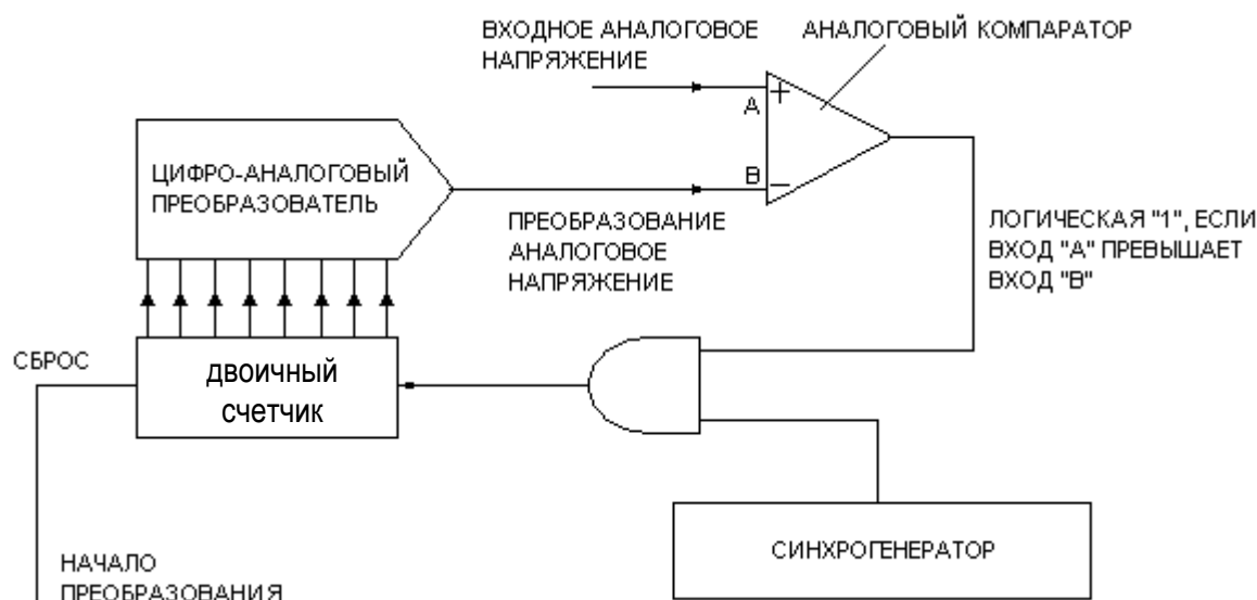
Рисунок 15.2 - Аналогово-цифровой преобразователь с суммирующим счётчиком
